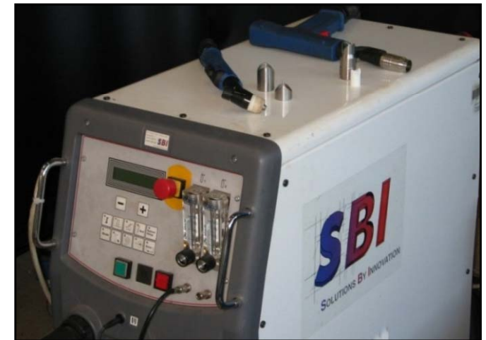
Stromquelle PMI 500 mit Punkt- und Lichtbogenschweißbrenner inklusive Aufsätze für Kehl- und Eckaußennähte
