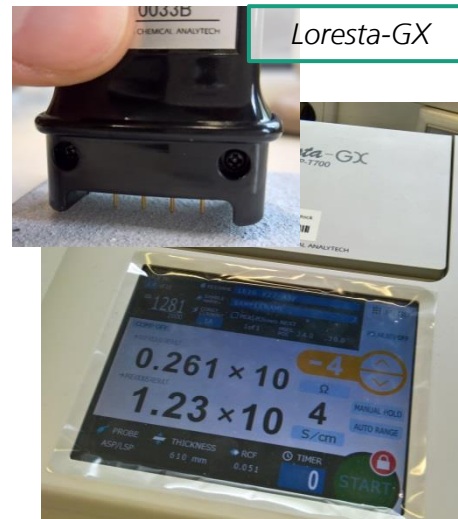
Messung der spezifischen elektrischen Leitfähigkeit einer metallischen Schicht
