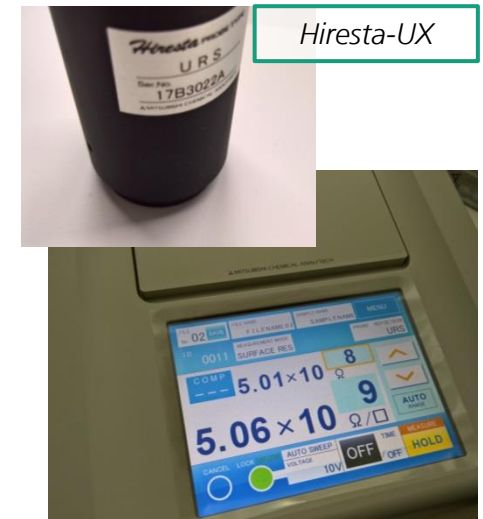
Messung des spezifischen Oberflächenwiderstands einer Keramik
