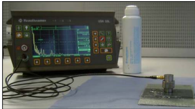
Prüfung einer Klebverbindung mit dem USN 60
