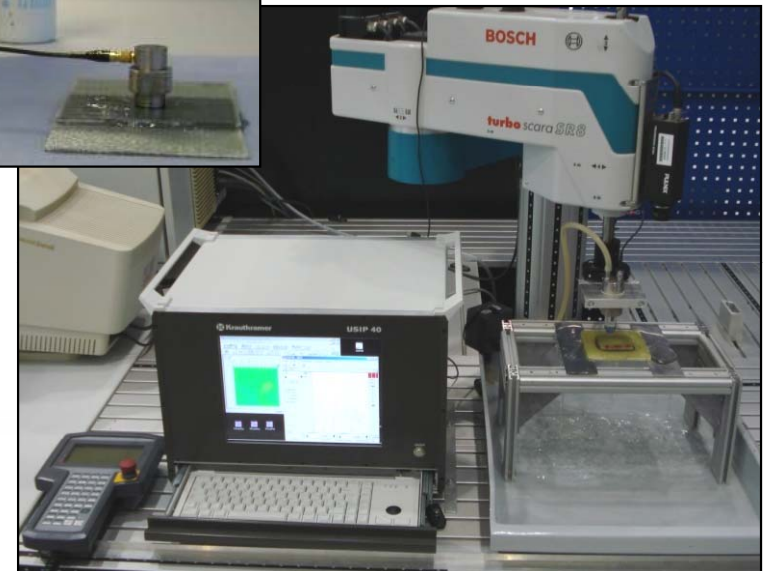
Automatisierter US-Prüfplatz mit Wasserstrahleinkopplung zur Aufnahme von C-Bildern
