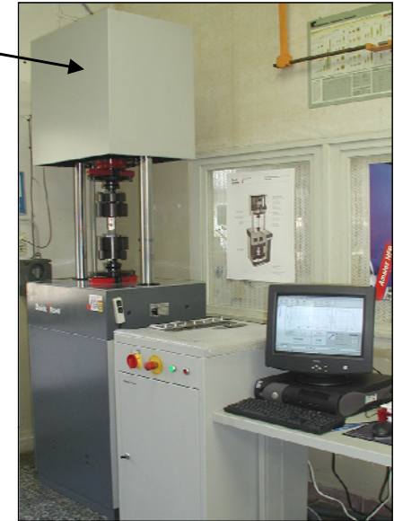
Hochfrequenzpulsator im Labor Fertigungstechnik bei Zeitfestigkeitsversuchen
