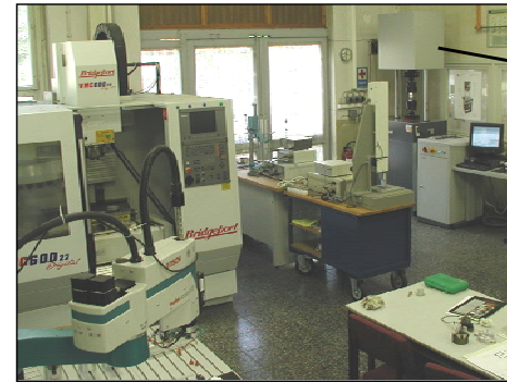
Hochfrequenzpulsator im Labor Fertigungstechnik bei Zeitfestigkeitsversuchen
