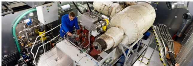
Motorenprüfstand zur Erforschung alternativer Kraftstoffe. (© Holger Martens)
