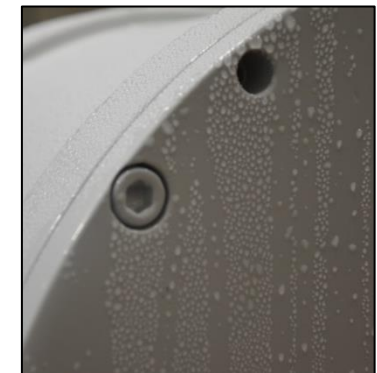
Taupunktunterschreitung an der Oberfläche einer Komponente
