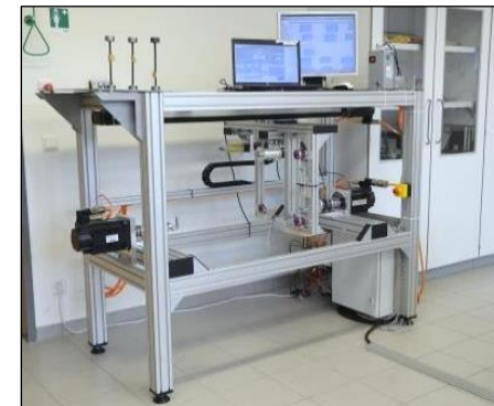
Am Fh AGP entwickelte Stranglege- und Wickelanlage zur Bauteilherstellung mit definierten Prozessparametern
