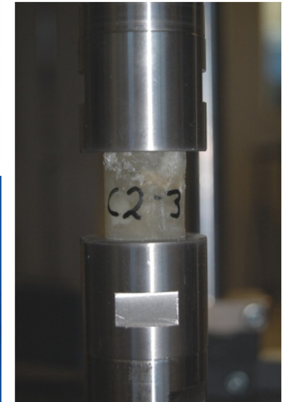
Druckprüfung von Recycling-Verbundmaterial
