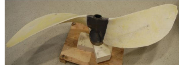
1. Prozessschritt: Herstellung Schaumkern (Propellerrohling)
