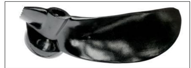
3. Prozessschritt: Harzinjektion per RTM-Verfahren
