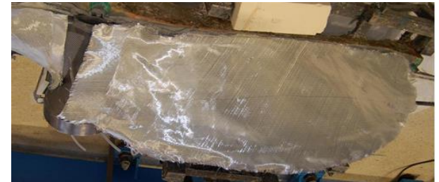
2. Prozessschritt: Drapierung der Verstärkungsfasern
