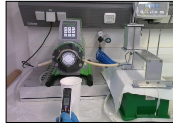
Herstellung von Auflagern aus Epoxidharz mit Hilfe des VARTM-Verfahrens
