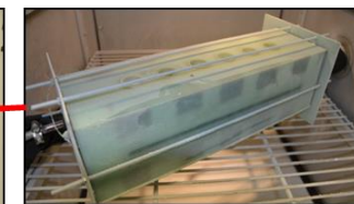
Prüfung von Epoxidharz zur Simulation der klimatischen Bedingungen am Tank mit einem \Delta T = 140\text{ K}
