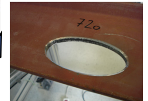
Bearbeitete Beschnittkanten mit Radius > 2 mm
